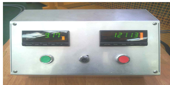
그림 13. 최대 출력에서 측정된 직류 전압과 전류 Fig. 13. Measured DC voltage and current value at maximum output
