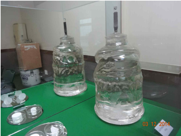
그림 14. 실험에서 얻어진 사파이어 결정 Fig. 14. Glowing sapphire silicon ingot at experimental the converter system
