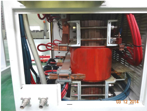
그림 5. 제작된 고주파 변압기 Fig. 5. Manufacturing HF Transformer
