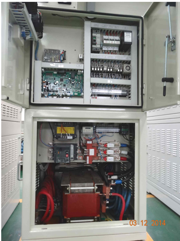
그림 6. 제작된 컨버터 시스템의 형태 Fig. 6. Assembly appearance of converter system
