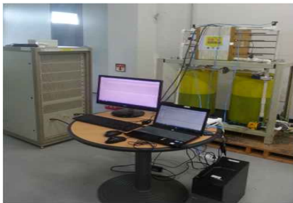
그림 18. 4.8kWh급 VRFB 충방전 시스템 Fig. 18. VRFB Charging Discharging System of 4.8kWh
