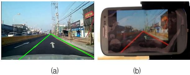
그림 21. 주간 도시 도로 상황에서의 (a) S/W 테스트 결과 (b) H/W 테스트 결과 (클립5)
