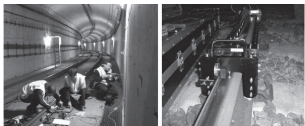
<그림 7> 현장 가속도 측정(왼손), 레일 거칠기 측정(오른쪽)
