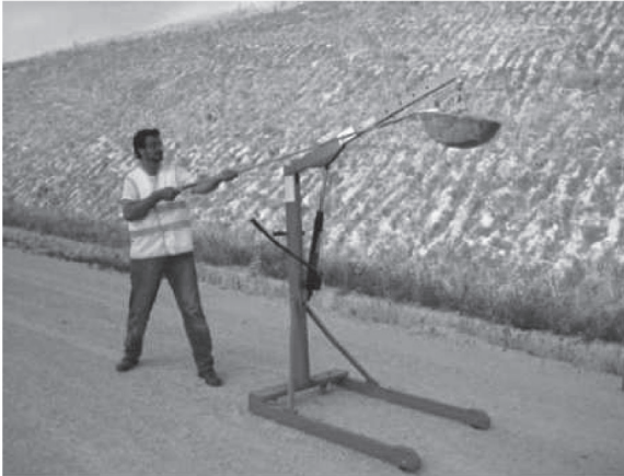
〈그림 4〉 SENER에서 개발한 충격기(왼쪽) 및 SASW로부터의 지반진동 전파 결과(오른쪽)
