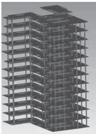
〈그림 5〉 FEM-SEA 하이브리드 진동 모델(왼쪽) 및 SEA의 예측 모델(오른쪽)
