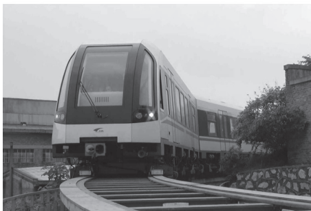
〈그림 3〉 주저우 시험선 (구배 = 7%, 최소곡선반경 = 50m) (자료제공 : CSR Zhuzhou Electric Locomotive Co.,Ltd)
