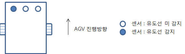
그림 5 무인운반차 전면부에만 가이드 센서가 존재하는 경우 Fig. 5 The case that only one set of guide sensors are attached on the front of an AGV
