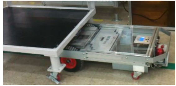
그림 4 대차 방식의 무인운반차 Fig. 4 AGV with a trailer
