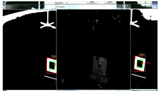
Fig. 14. Implemented stereo image registration using depth map 그림 14. 스테레오 영상정합을 통한 깊이정보지도 구현
