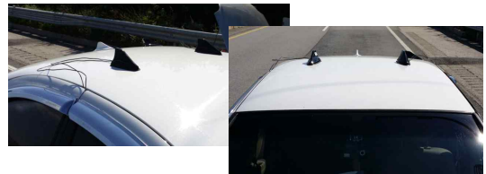
Fig. 6. Antenna attached on top of a test car 그림 6. 테스트 차량에 장착된 안테나 형태
