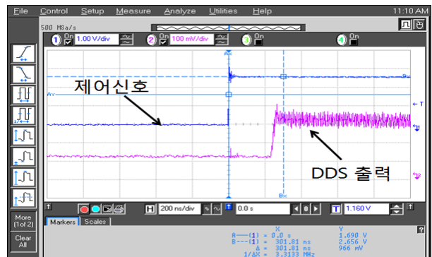
그림 15. 제작된 DDS 모듈의 동조 속도 측정 결과 Fig. 15. Measured settling time of the DDS module.
