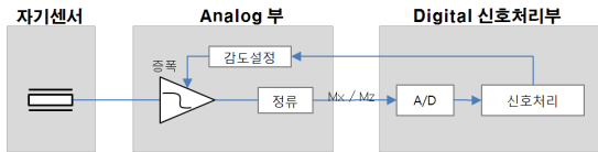
그림 9. 일반적인 자력계의 구조 Fig. 9 General Magnetometer design
