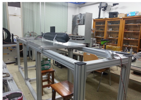
그림 17. 모형잠수함의 자기장분포 측정 Fig. 17 Measuring Magnetic Field test of Submarine
