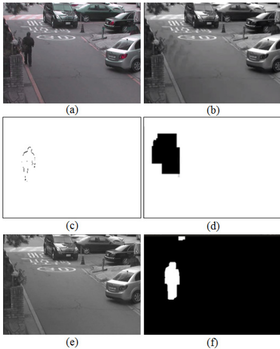
그림 1. 움직임정보를 이용한 배경모델링 (a) 입력 프레임 (b) 단순 이동평균에 의한 배경모델링에 의한 배경영상 (c) 차영상 (d) 차영상에 대한 팽창연산 (e) 움직임정보를 이용한 배경모델링에 의한 배경영상 (f) (e)를 사용한 전경영역 추출
