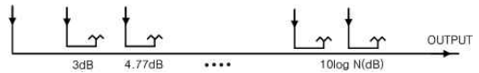
그림 3. Traveling wave 결합기 구조 Fig. 3 The block for coupler with Traveling wave structure
