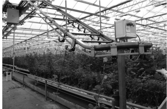
그림 6. 이동식 베드 및 자동 운송시스템
