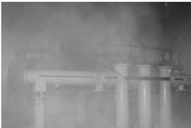
[그림 3] 옥내변전소 미분무소화 실험(좌측) 및 옥외 변압기 미분무소화 실험(우측) 모습
