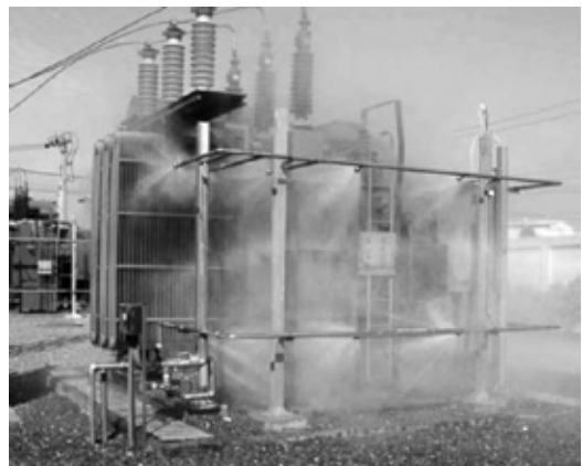
[그림 3] 옥내변전소 미분무소화 실험(좌측) 및 옥외 변압기 미분무소화 실험(우측) 모습
