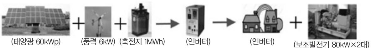
[그림 1] 혈도 Hybrid System 발전설비 구성
