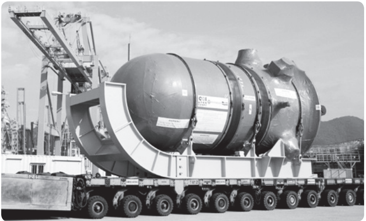
두산중공업이 웨스팅하우스의 수주를 받아 제작한 신형 원자로(AP1000TM)가 중국 하이양 원자력발전소에 설치되기 위해 출하되고 있는 모습. (2011)
