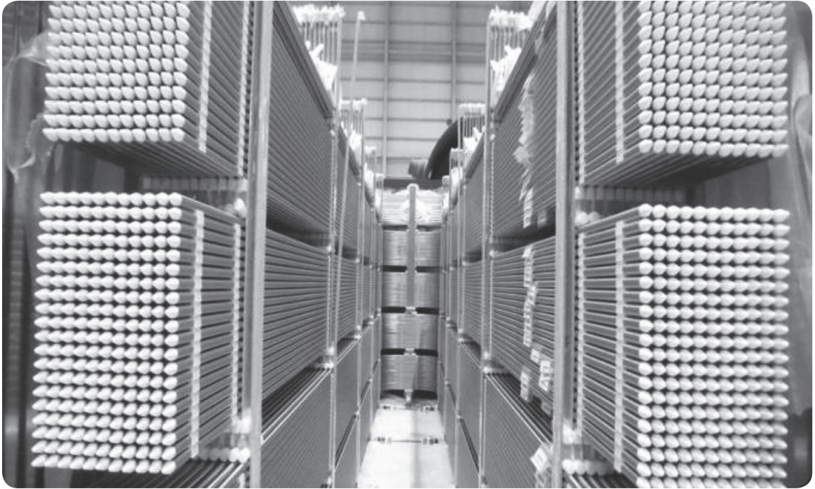
원전 증기발생기용 전열관. 증기발생기 공급 가격의 약 1/3 이상을 차지하고 있는 핵심 부품인 전열관은 해외 전열관 공급 업체에 종속되어 있어서 국산화 공급이 시급한 실정이다.
