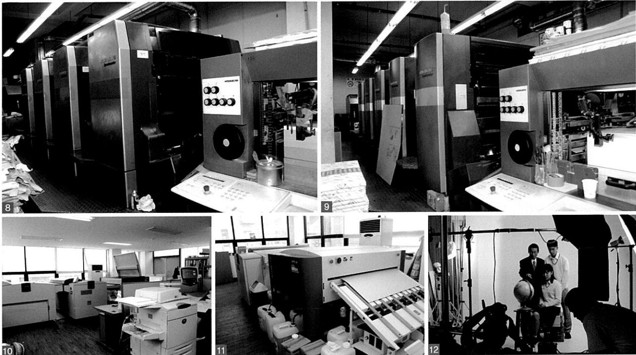
8-9. 흥진씨앤피에 설치된 하이델 4색기와 하이델 5색기 10-11. 아그파 이발론 CTP와 디지털인쇄기 제록스 도큐컬러 5065 12. 흥진씨앤피에서는 사진촬영 등 모든 디자인 작업을 진행하고 있다.
