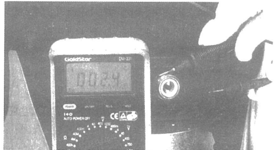
【그림 5】 전원 플러그와 세척기 호스 연결부 금속 사이 저항(2.4Ω)
