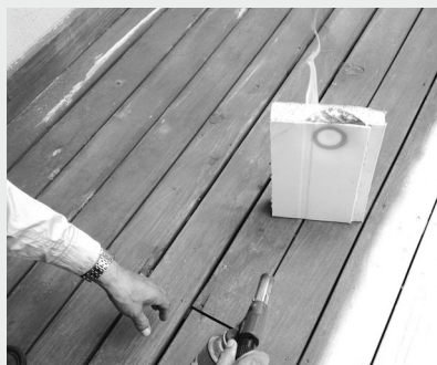
▲ 일반 50mm 샌드위치패널의 경우 가스토키를 대자마자 불이 붙어 화재 발생
