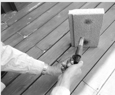
▲ 50mm샌드위치 패널에 단열재를 바르고 난 후 가스토키 가열 - 아무런 반응 없음
