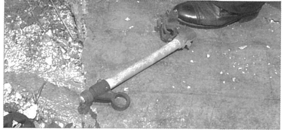
【그림 3】 피재자가 교체 시도한 C.O.S 2개중 1개 모습 (사고유발 부품)
