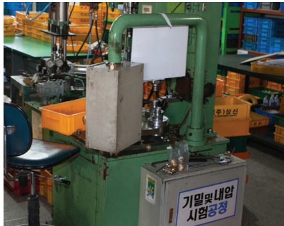
2층에서는 기밀 및 내압시험 공정과정을 거친다. 품목별로 분류하여 정리된 자재와 기밀 및 내압시험기
