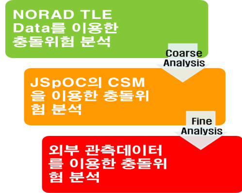
그림 2. KARISMA 시스템의 충돌확률 분석과정
