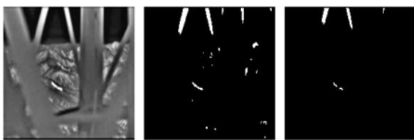
(입력영상) (TH=190) (TH=230) 그림 1. 고정 문턱치를 이용한 화염 검출 영상
