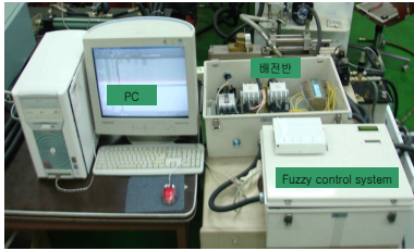
그림15. PC, 전력 제어부 그리고 퍼지 제어시스템의 모습.
