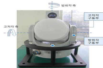
그림 11. 알고리즘 검증용 2축 안정화 짐벌 시스템 Fig. 11. 2-axis stabilized gimbal system for verifying the algorithm
