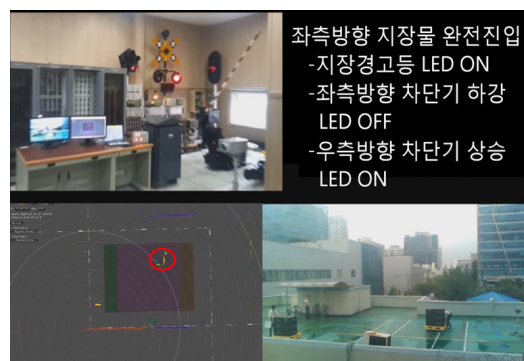
그림 19 좌측방향 지장물 진입 시험 Fig. 19 Test for left direction obstruction entry
