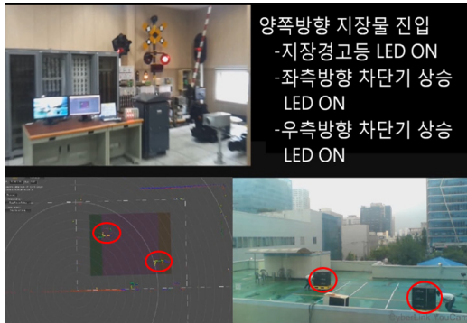
그림 20 양쪽방향 지장물 진입 시험 Fig. 20 Test for bidirectional obstruction entry
