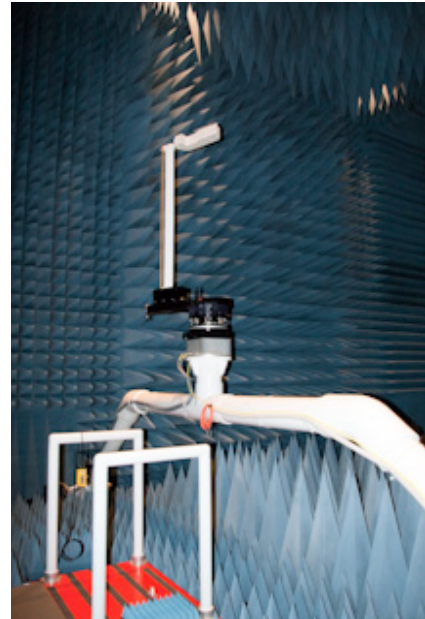
그림 11 피측정 중인 안테나 Fig. 11 Antenna under test
