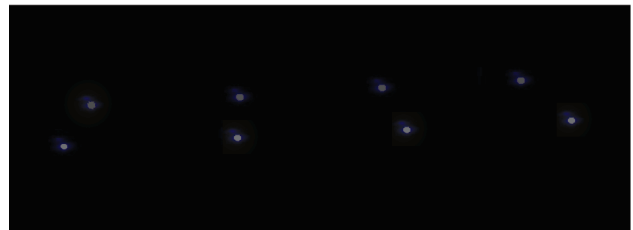
그림 2 부분방전 광방출 Fig. 2 Light Emission of Partial Discharge
