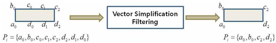
그림 8. DP 알고리즘을 이용한 기상데이터의 벡터 변환 시 잉여 좌표점 제거
