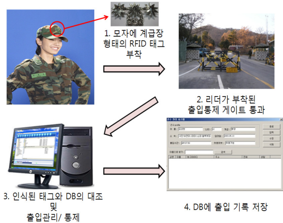
그림 6. UHF RFID 계급장을 사용한 군 보안지역 출입관리시스템 Fig. 6. Military Security entrance control system using military UHF RFID insignia tag
