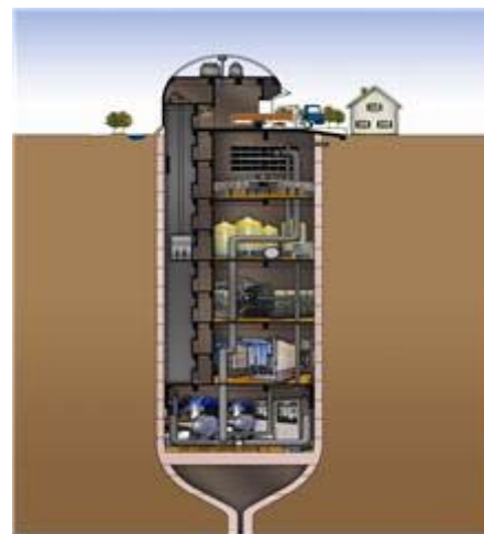
그림 1. 수직형 정수처리시설 개념도 (예: 지하형) Fig. 1 Concept of vertical type WTP (ex: underground-type)
