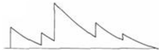
그림 4. 감마선 센서의 출력 신호 Fig. 4 Output signal of gamma-ray sensor
