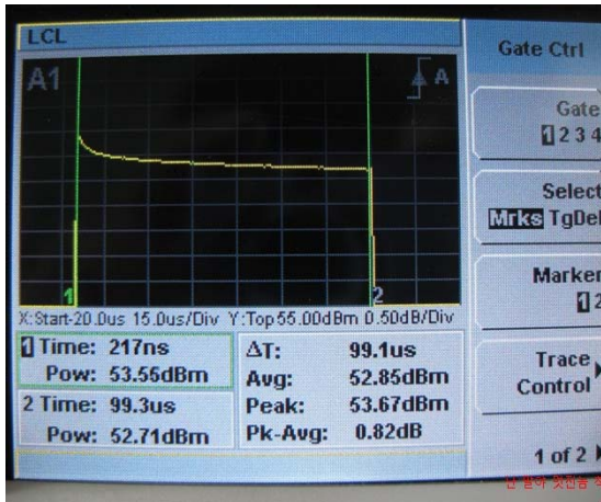
그림 12. X-대역 200W SSPA 펄스특성 Fig. 12 Pulse characteristic of X-Band 200W SSPA
