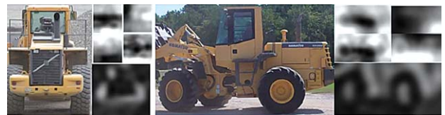
그림 4. Wheel loader detection templates (Park and Brilakis 2012a)
