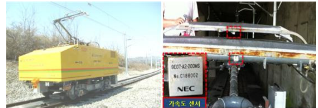
그림 7 절연구분장치 현장운영 모의시험을 위한 팬터그래프 집전판에 부착한 가속도 센서
