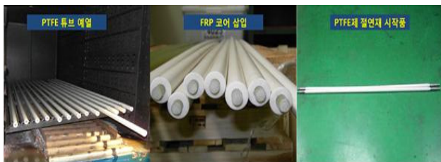
그림 5 PTFE제 절연구분장치 개발 시작품 제작 Fig. 5 The Prototype of the PTFE Section Insulator
