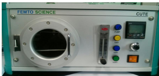
사진 1 플라즈마 처리 장치 Fig. 1 Plasma treatment device
