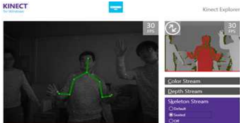
그림 5. Kinect SDK에서 가려진 사람 인식 실패. 우측에 가려진 사람은 인식되지 못함
