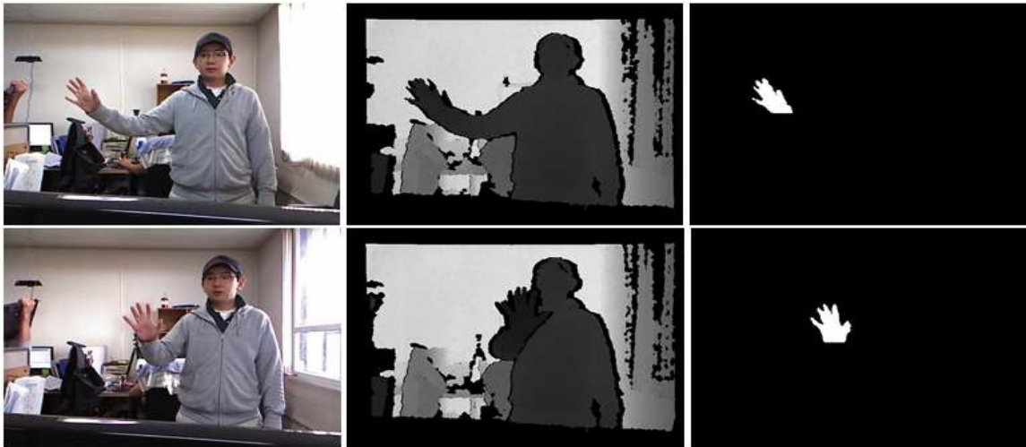
그림 15. 깊이 카메라의 분해능이 떨어져서 손이 깨끗하지 않게 분리된 결과 영상
