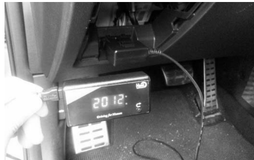
(그림 9) OBD 포트와 ECU Data Logger의 연결
