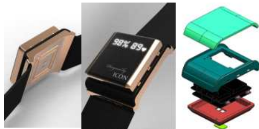
그림 8. SpO 2 센서 노드를 위한 목업 디자인 Fig. 8 The Mock-up Design for the SpO 2 Sensor Node
