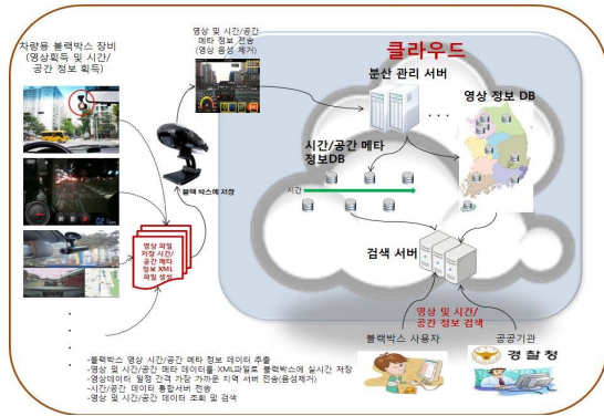
그림 1. 차량용 블랙박스 영상 통합 시스템 구조도 Fig. 1 System architecture for integrated vehicle black box video
