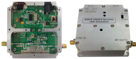
그림 8. 제작된 저잡음 증폭기 Fig. 8 The low-noise amplifier designed
