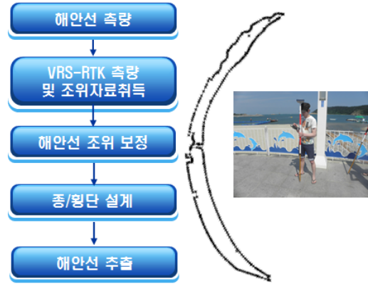
그림 2. VRS-RTK에 의한 해안선측량
