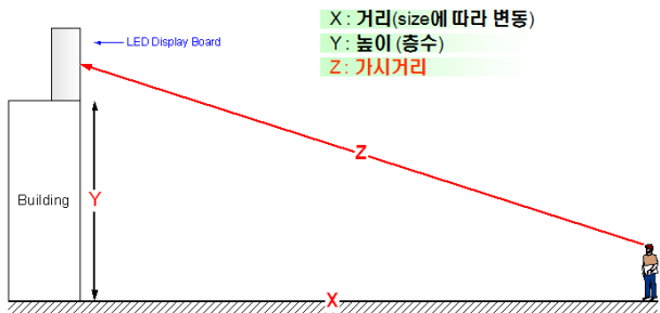
그림 9. 거리와 높이에 따른 가시거리 Fig. 9. Line-of-sight according to the distance and height.
