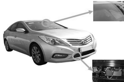
Fig 9. 레이더/카메라 센서장착 위치
