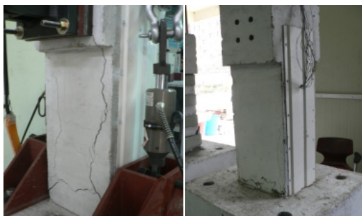
〈Fig. 10〉 Crack patterns(B2-2.)
