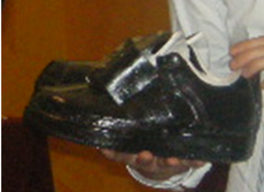
그림 5. 스트레인 센서가 포함되어 제작된 신발 Fig. 5 Photograph of the fabricated shoes installing strain sensor
