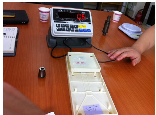
그림 2. 포장 약을 이용한 무게 측정 시험 Fig. 2 The weight measurement test by a load cell
