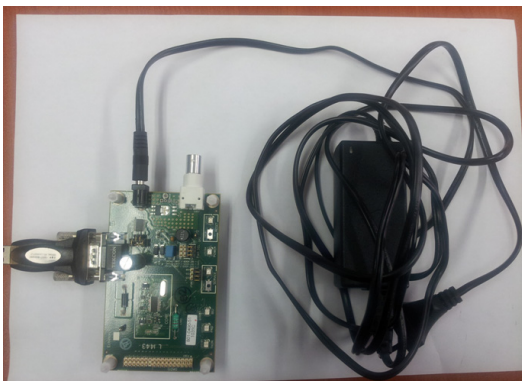
그림 5. DCU로 사용하는 PLC 보드 Fig. 5 PLC board for using DCU
