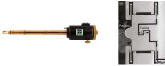
Fig. 6. Nano indentation holder and PTP (push-to-pull) device from Hysitron. 것이 가능하며, 기존의 정성적인 실시간 인장시험의 단점을 극복할 수 있다.
